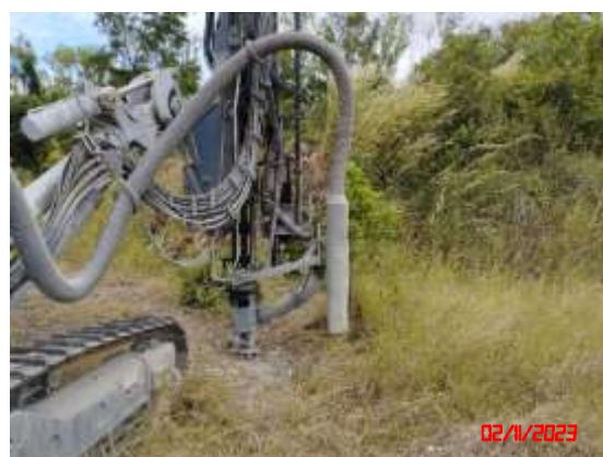
รูปที่ 5 เครื่องเจาะระเบิดที่มีอุปกรณ์เก็บฝุ่นติดไว้ที่หัวเจาะ
